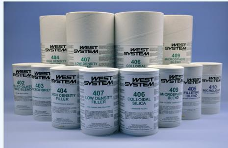
SYSTEM Epoxy in einem Verhältnis von 25% nach Gewicht beigemischt, ergibt eine dicke Paste, die sorgfältig mit einem Pinsel in die Reparaturstelle getupft wird. Mit einem Tape oder Abreißgewebe erhält man eine glatte Oberfläche. Typische Anwendungen sind unter anderem tiefe örtliche Osmoseschäden, kleine Schäden an Dinghi-Rudern oder Schwertern oder Schlagschäden an scharfen Kanten von GFK-Booten.
