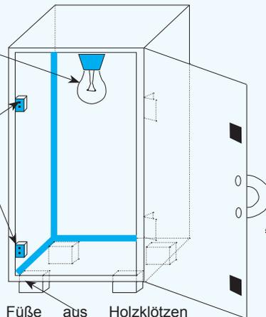
Füße aus Holzklötzen halten das WEST SYSTEM Epoxidharz vom kalten Boden ab und erleichtern das Anheben.
