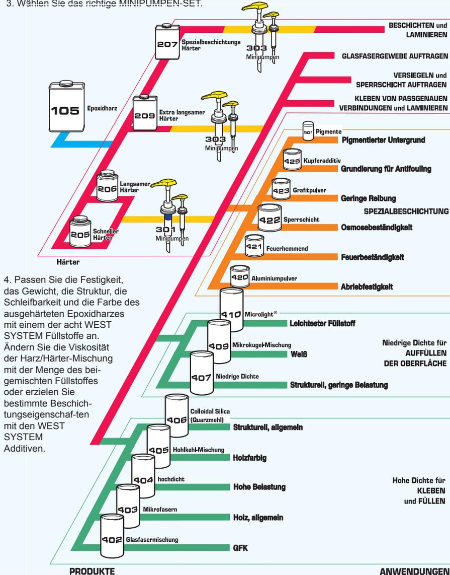
4. Passen Sie die Festigkeit, das Gewicht, die Struktur, die Schleifbarkeit und die Farbe des ausgehärteten Epoxidharzes mit einem der acht WEST SYSTEM Füllstoffe an. Ändern Sie die Viskosität der Harz/Härter-Mischung mit der Menge des beigemischten Füllstoffes oder erzielen Sie bestimmte Beschichtungseigenschaften mit den WEST SYSTEM Additiven.
