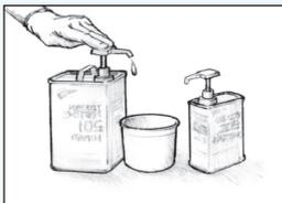
**Abbildung 2** Dosieren Sie die richtigen Anteile von Harz und Härter.
