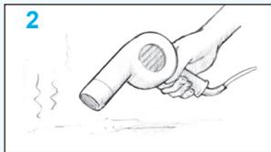
**Abbildung 7** Trocknen Sie die Fläche. Lassen Sie nasse poröse Flächen. Stellen Sie eine Flächen gründlich austrocknen oder raue Oberfläche her, in der sich beschleunigen Sie die Trocknung das Epoxidharz verankern kann. durch Wärmezufuhr oder einen Fön.
