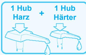
Mit den Minipumpen erhalten Sie bei jeweils einem Pumpenhub Harz und einem Pumpenhub Härter das richtige Mischungsverhältnis.
