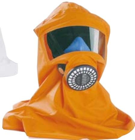
**Schutzhaube SR 345** ist für Verwendung zusammen mit Sundströms Halbmasken mit Filter bzw. Druckluftzusatz SR 307 oder zusammen mit SR 90 Airline vorgesehen. Die Haube besteht aus chemikalienbeständigem, beschichtetem Gewebe und schützt vor Spritzern und Tropfen. Die Haube wird so montiert, dass die Ausatemventile außerhalb der Maske zu liegen kommen. Dies reduziert die Gefahr von Kondensbildung.
