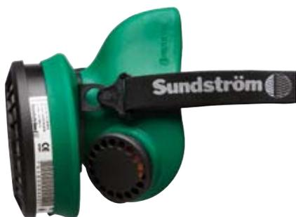
Die **Halbmaske SR 90-2** ist aus TPE hergestellt und in zwei Größen, S/M und M/L erhältlich. Die Maske ist mit zwei Ausatemventilen versehen, was einen äußerst geringen Ausatemwiderstand zur Folge hat. Die einfach verstellbaren Tragebänder stellen eine V-Schleife dar und sind mit einer großen schalenförmigen Kopfplatte versehen, was eine sichere und bequeme Passform gewährleistet. Der Druckluftzusatz SR 307 kann angeschlossen werden. Geprüft gemäß prEN 140:1996.
