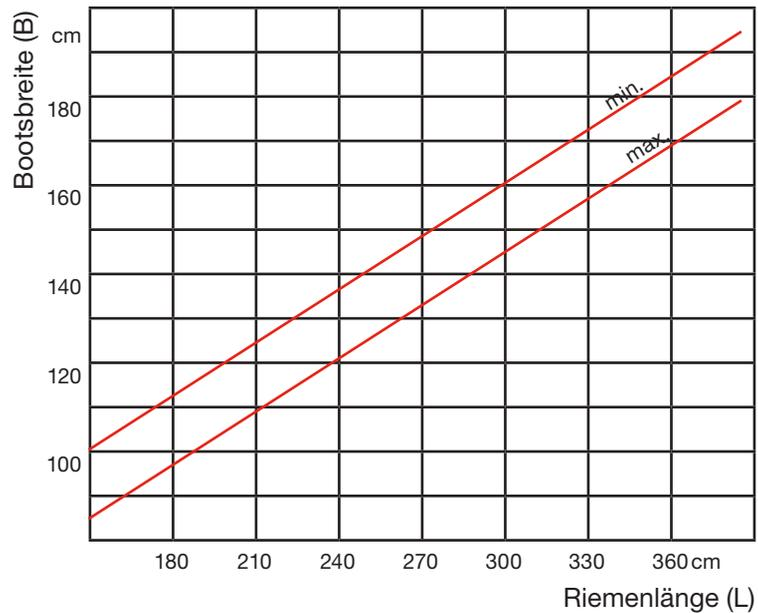
Zur Ermittlung der richtigen Riemenlänge kann folgende Faustformel verwendet werden:
