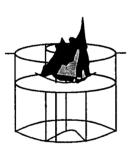
Die Flamme sollte von zitronengelber Farbe sein und keinen Rauch entwickeln. Wenn die Flamme nicht über dem Brenner-Ring brennt, nachdem der Ölregler wieder aufgedreht wurde, drehen Sie ihn weiter auf, bis die Flamme über dem Ring brennt.
