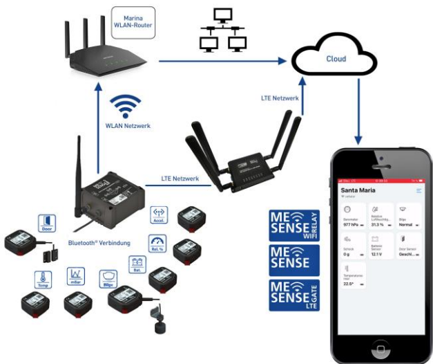
Abbildung 3 - ME SENSE Funktionsskizze
