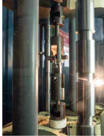
Zugprüfstand für mechanische Festigkeitsprüfungen
