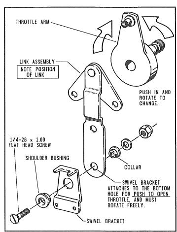
FIGURE 4 PUSH-TO-OPEN CONFIGURATION
