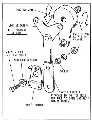
FIGURE 5 PULL-TO-OPEN CONFIGURATION
