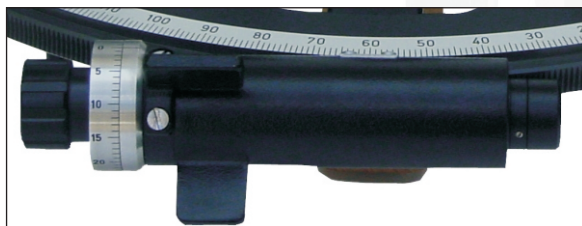
Abb. 5 - Teilungstrommel des Trommelsextanten
