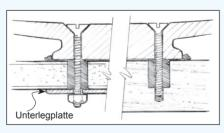
**Abbildung 18** Ziehen Sie die Schraube an, bis eine geringe Menge des Epoxidharzes aus der Fuge austritt.
