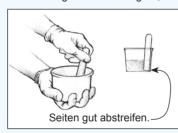
**Abbildung 3** Mischen Sie das Harz und den Härter gründlich für zwei Minuten, bei kälteren Temperaturen länger.
