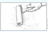
Abbildung 30 Rollen Sie das Epoxidharz gleichmäßig über einen kleinen Bereich aus. Tragen Sie das Epoxidharz als dünne Schicht auf.
