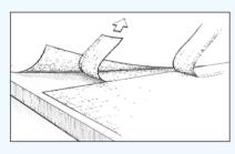
Abbildung 27 Entfernen Sie das abgeschnittene Stück, das oben liegt. Heben Sie dann die gegenüberliegende abgeschnittene Kante an, um die Überlappung zu entfernen.
