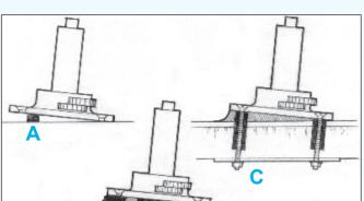
**Abbilduna** 19 Bringen Sie das Fundament mit Hilfe Klötzchens eines auf die gewünschte Höhe und füllen Sie den Hohlraum angedicktem Epoxidharz auf.
