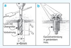
Abbildung 16 Bohren Sie Löcher mit Übergröße, um denBereichdesfreigelegten Kernmaterials und die um die Schraube aufgebrachte Epoxidharzmenge vergrößern.
