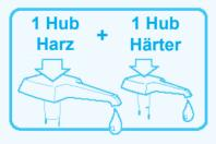
Mit den Minipumpen erhalten Sie bei jeweils einem Pumpenhub Harz und einem Pumpenhub Härter das richtige Mischungsverhältnis.
