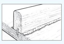
Abbildung 11 Fixieren Sie die Teile, bevor das Epoxidharz in den Geleezustand übergeht.
