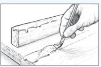
Abbildung 9 Tragen Sie die Harz/Härter-Mischung auf die Klebeflächen auf.
