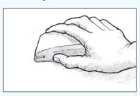
**Abbildung 32** Schleifen Sie die Oberfläche glatt.
