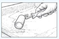
Abbildung 28 Beschichten Sie die Oberfläche, um die Gewebestruktur vollständig auszufüllen, solange das getränkte Glasgewebe noch klebrig ist.
