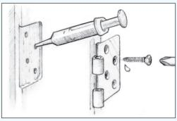
Abbildung 15 Tränken Sie normales Bohrloch vor und drehen Sie die Schraube ein
