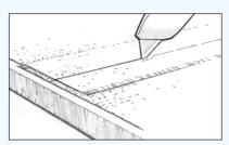
Sie Abbildung Schneiden Überlappungen ab. wenn das Epoxidharz in den Geleezustand gewechselt hat, jedoch noch nicht ausgehärtet ist.
