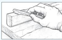
Abbildung 10 Tragen Sie angedicktes Epoxidharz auf eine der Klebeflächen auf.
