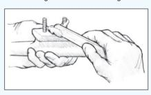
Abbildung 17 Streichen Sie die Unterseite des Beschlags und das Schraubengewinde mit angedicktem Epoxidharz ein.
