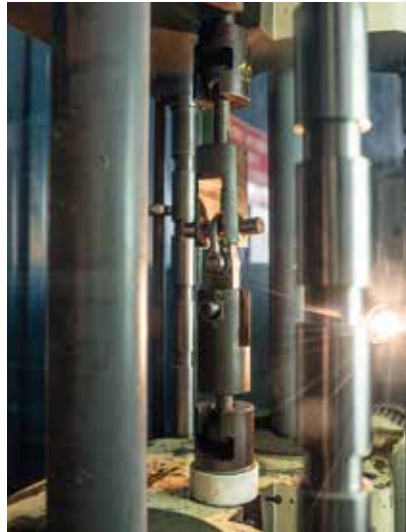
Zugprüfstand für mechanische Festigkeitsprüfungen
