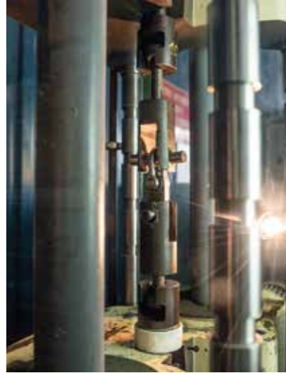
Zugprüfstand für mechanische Festigkeitsprüfungen
