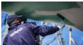
Auftragen von Antifouling auf Primer oder Haftgrund
