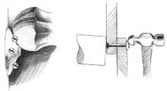
7. Nachdem die letzte Niete gesetzt worden ist, sollte jede Niete im Rumpf noch einmal mit zwei Schlägen auf den Nagelkopf, während von innen mit dem Eisengewicht auf der Niete gegengehalten wird, nachgezogen werden. Dadurch wird der Rumpf gehärtet.
