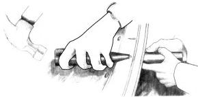
5. Mit 4-6 Hammerschlägen wird nun die Scheibe mit der runden Hammerseite getrieben, während von Außen gegengehalten wird. Das abgekniffene Ende des Nagels ragt nun ein Stück aus der Scheibe heraus. Für diese Arbeit hat sich der spezielle Nietenzieher bewährt.
